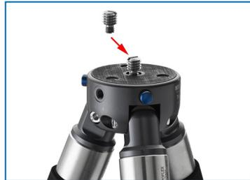
Nach Entfernen der Basisschraube kann der mitgelieferte 3/8"-Gewindestift von oben eingesetzt werden.
