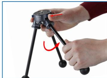
Die 20°/40°/60°-Rastung der Beine wird durch Druck auf die blauen Knöpfe entriegelt. Beim Herunterschwenken rasten die Beine automatisch ein.
