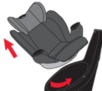
3. Retire los anclajes LATCH/SAU de las ubicaciones de almacenamiento en la parte trasera de la base como se muestra en la pág. 51.
