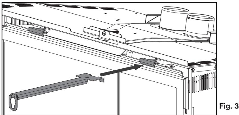
3. Inversez ces étapes pour réinstaller la barrière de protection et la porte. Assurez-vous que la barrière de protection et correctement installé.
