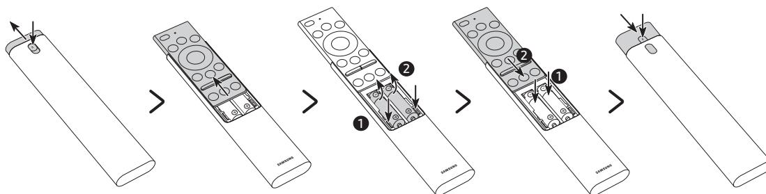
1. Appuyez sur la touche ▲ en haut à l'arrière de la télécommande Télécommande intelligente Samsung. Le corps de la télécommande ressort légèrement.
