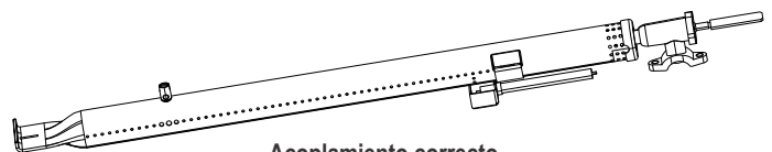
Acoplamiento correcto del quemador con la válvula
