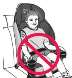
Les ceintures de sécurité sous-abdominale et baudrier **DOIVENT** passer dans le guide inférieur de la ceinture et être attachées à la boucle (modèles canadiens seulement).
