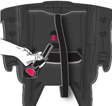
Remettre en place l'ancrage de la sangle d'entrejambe en la faisant passer par l'ouverture à partir du fond du dispositif de retenue pour enfant.
