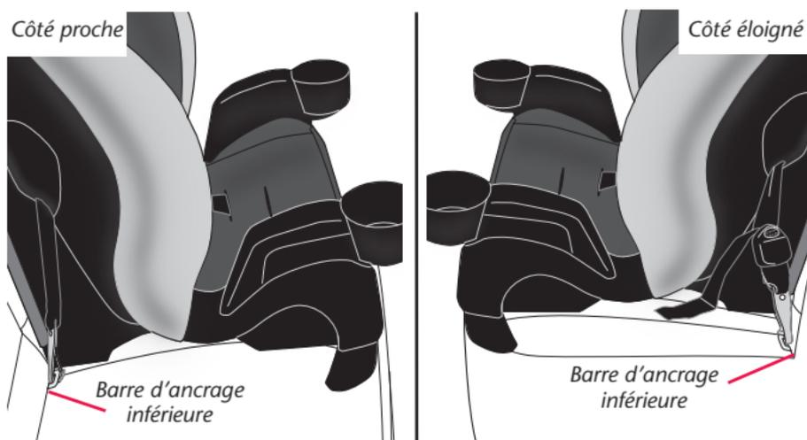
**IMPORTANT :** Vérifier que les deux connecteurs d'ancrage inférieurs sont orientés vers le haut et que les sangles ne sont pas tordues.
