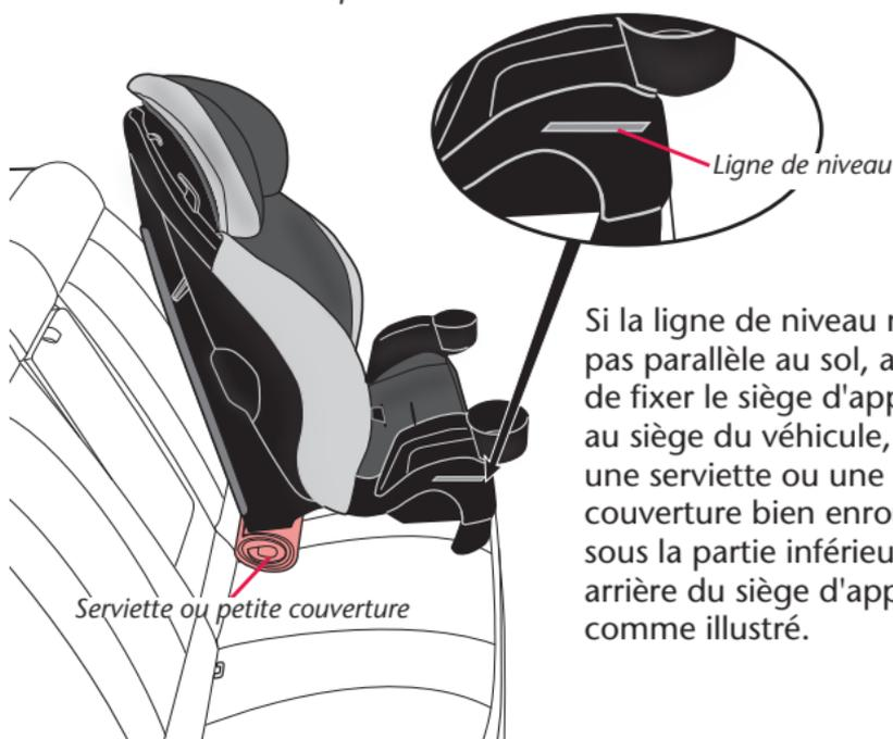
Si la ligne de niveau n'est pas parallèle au sol, avant de fixer le siège d'appoint au siège du véhicule, placer une serviette ou une petite couverture bien enroulée sous la partie inférieure arrière du siège d'appoint, comme illustré.
