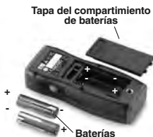
Figura 5 – Reemplazo de las baterías
