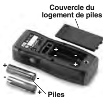
Figure 5 – Remplacement des piles
