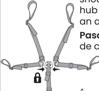
**Paso 2:** Deslice los conectores de cintura y hombros dentro del centro hasta que encajen en su lugar con un “clic” audible.
