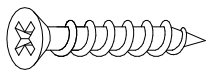
35 x 2 M4 x 30mm Screw M4 x 30mm de la vis M4 x 30mm el tornillo
