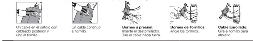
Un cable en el orificio con cableado posterior y uno al tornillo. Un cable continuo al tornillo. **Bornes a presión:** Tire el destornillador. Tire el cable hacia fuera. **Bornes de Tornillos:** Afloje los tornillos. **Cable Enrollado:** Gire el tornillo para aflojarlo.
