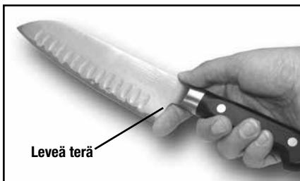
Kuva 16 Jos veitsessä on huomattavan leveä terä, sormen pitäminen terän tukena saattaa helpottaa teroitusta.
