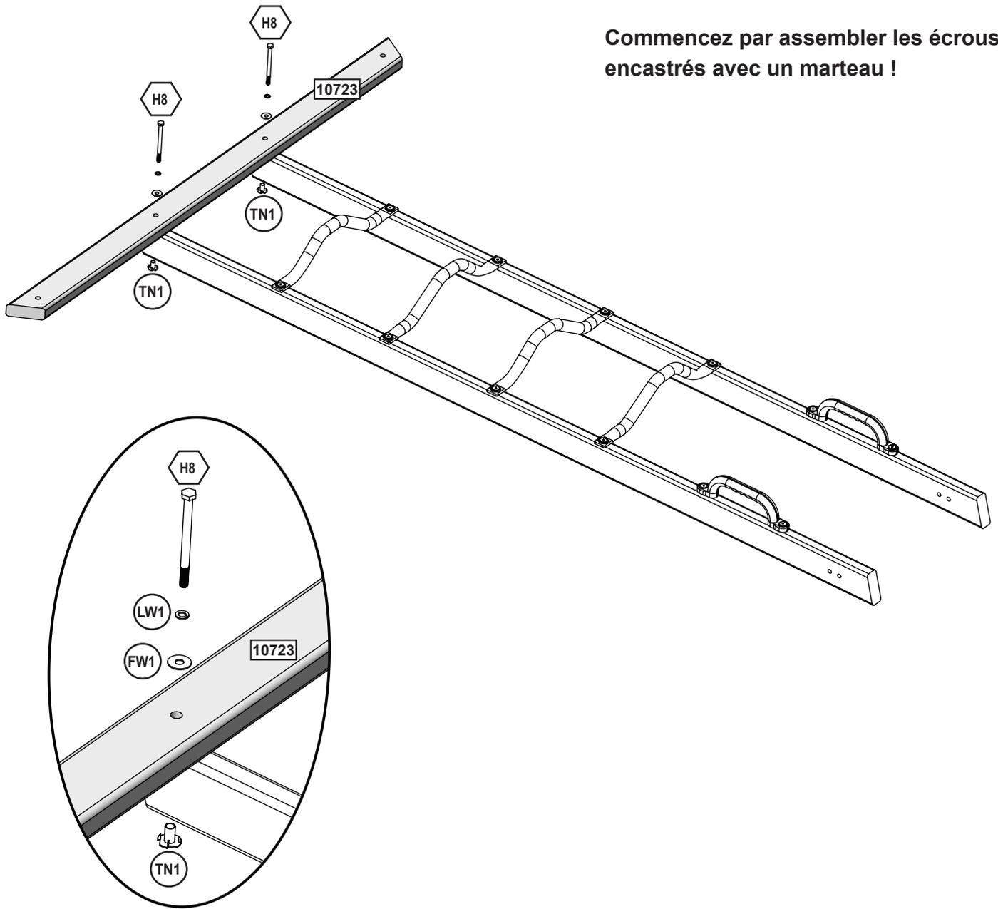
Commencez par assembler les écrous encastrés avec un marteau !
