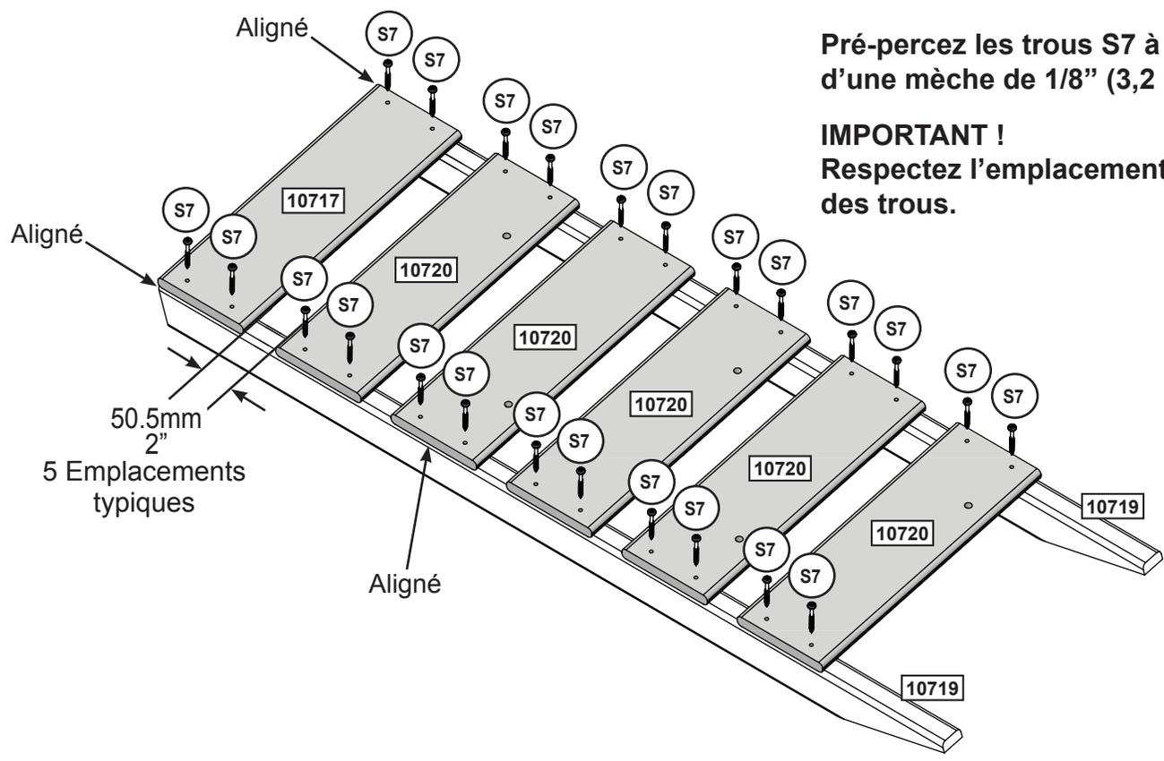
Pré-percez les trous S7 à l'aide d'une mèche de 1/8" (3,2 mm).
