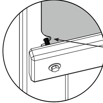
Tirez le tissu de façon à ce que les boulons puissent passer dans les trous.
