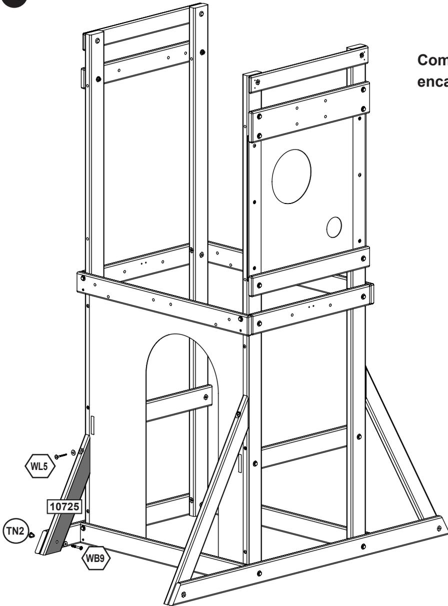
Pré-percez les trous à l'aide d'une mèche de 3/16" (4,8 mm).
