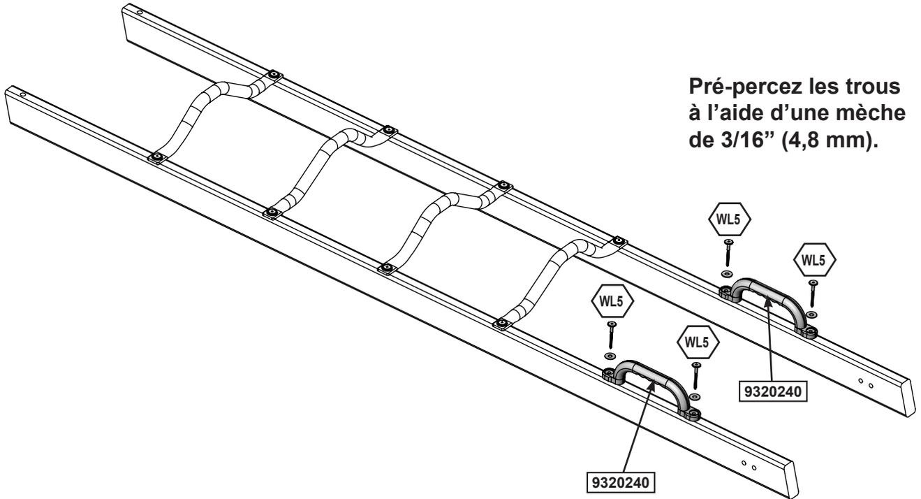
Pré-percez les trous à l'aide d'une mèche de 3/16" (4,8 mm).
