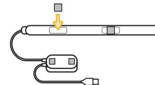
3. Appliquer 2 pièces de ruban de fixation double-face au dos de la lumière intelligente sous le berceau et 2 pièces au dos de l'unité de contrôle.
