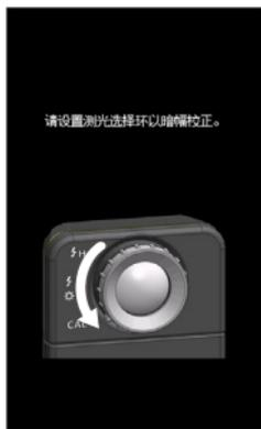
※ 显示“请设置测光选择环以暗幅校正。”的信息后，请将光量转换环②设置到暗幅校正位置。
