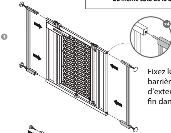
Fixez les cadres d'extension au cadre de barrière en insérant les chevilles des cadres d'extension dans les trous prévus à cette fin dans le cadre de barrière.
