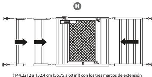
**Nota:** Este manual de instrucciones ilustra la instalación de la configuración de barrera D. Si elige la configuración de barrera A, vaya al paso 2. De lo contrario, siga el paso 1 utilizando los marcos de extensión adecuados que mejor se adapten a su necesidad.
