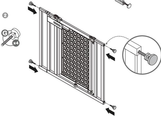
Faites glisser les vis de tension dans les trous du bas et du haut des deux côtés de l'assemblage. Les orifices ne sont pas filetés et les boulons de tension doivent coulisser librement.
