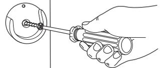
**!** Coloque la barrera en el centro de la abertura. Asegúrese de que la parte inferior de la barrera esté completamente plana con respecto al suelo. Deslice los pernos de tensión hacia fuera hasta que toquen el marco de la puerta o la pared.
