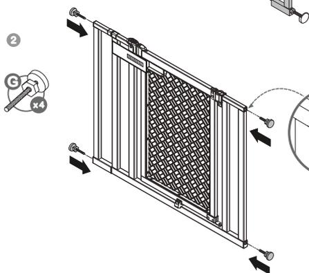
Deslice los pernos de tensión en los agujeros superior e inferior de ambos lados del ensamblaje de la barrera. Los agujeros no tienen rosca y los pernos de tensión deben deslizarse libremente.
