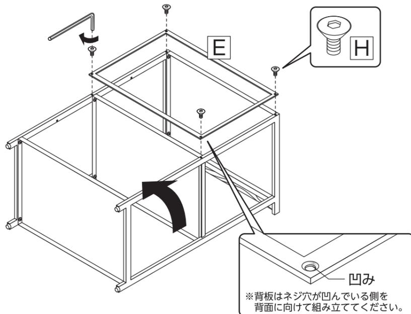
**4** 本体設置後に仮止めたネジをすべてしっかり締めて固定してください。
