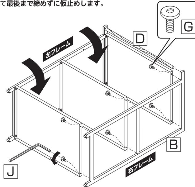
**3** **2**で組み立てたフレームを裏返します。背板をフレームに背板用ネジで六角レンチを使って最後まで締めずに仮止めます。
