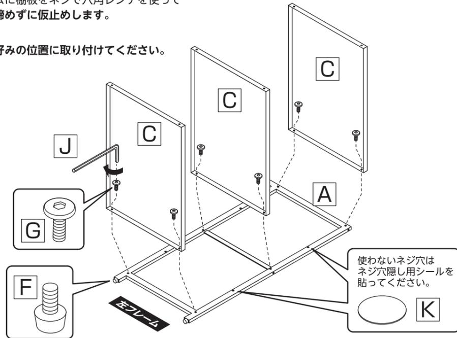
**2** **1**で組み立てた左フレームを倒します。ハンガーバーを右フレームで挟み込み、棚板をネジで六角レンチを使って最後まで締めずに仮止めます。
