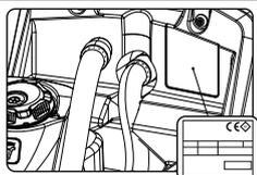
La placa de la matrícula se sitúa dentro del tanque solución y contiene las características generales de la máquina, especialmente el número de serie de la misma. El número de serie es una información muy importante que se debe comunicar en cualquier pedido de asistencia o compra de piezas de repuesto. En la placa de matrícula se pueden leer las siguientes indicaciones:
