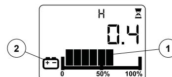
En el panel de mandos se encuentra la pantalla de control en cuya parte inferior se puede ver el nivel de carga de las baterías.
