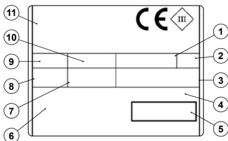
1. El valor indicado en Kg del peso de las baterías de alimentación de la máquina.
