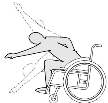
Placer les roulettes avant de façon à ce qu'elles soient le plus vers l'avant possible et embrayer le dispositif de blocage des roulettes.
