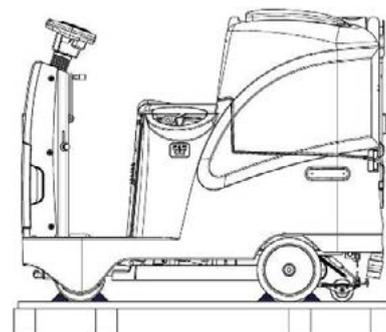
5. Sirviéndose de un plano inclinado, bajar la máquina del pallet empujándola en marcha atrás. No montar la boquilla de aspiración trasera antes de descargar la máquina y evitar golpes violentos en la bancada cepillos. Para montar la boquilla de aspiración, leer el apartado "MONTAJE DE LA BOQUILLA DE ASPIRACIÓN".
