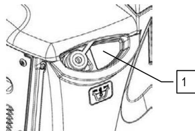
Controlar que el tapón del filtro solución (2), colocado debajo del depósito solución en la parte delantera izquierda de la máquina, esté cerrado correctamente.
