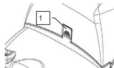
2. Sujetar el depósito recuperación y girarlo hasta que el muelle a presión se apoye en el depósito solución
