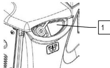
3. Cerrar el grifo del agua llevando hacia arriba la manivela específica (en la parte izquierda de la columna de dirección)
