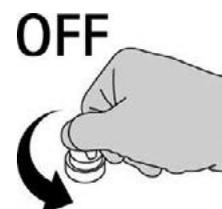
5. Desconectar el tubo (4) del alojamiento, desenroscar el tapón de descarga y vaciar el tanque de recuperación.
