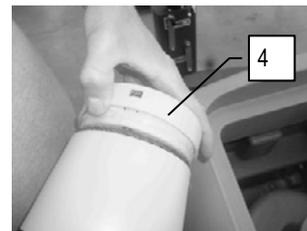
6. Retirar el filtro de aspiración (5) del cuerpo del flotante
