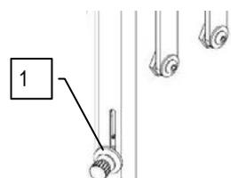
11. Si es necesario vaciar el depósito solución, mover hacia abajo la manivela (1)
