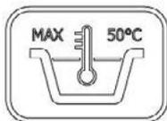
Símbolo que indica la temperatura máxima del agua con la que se puede llenar el tanque de solución
