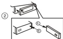
1. Fije primero el panel en el lado derecho, con el punto B de la unidad principal tocando el punto A del P.C.D. (como se muestra en la imagen).
