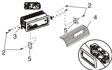
1. Seleccione una posición donde los orificios de los tornillos del soporte y los orificios de los tornillos de la unidad principal queden alineados (ajustados) y apriete los tornillos en los 2 sitios a cada lado.
