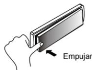
2. Presione el P.C.D. sobre el lado izquierdo a la altura de la mitad del P.C.D. hasta oír un clic.
