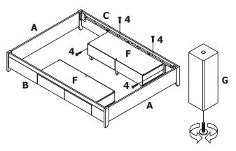
TURN LEVELER UNDERNEATH STORAGE FEETS (**G**) TO ADJUST THE STORAGES (**F**) LEVEL AS SHOWN ON ILLUSTRATION.
