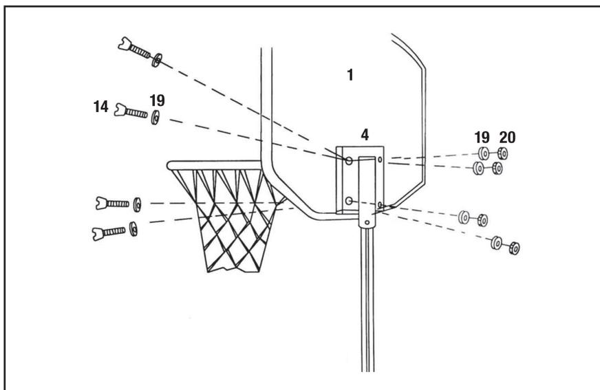
Utilisez quatre boulons de jante (14) pour fixer la jante de basket-ball (2), du côté avant, à travers les trous du panneau arrière (1) et à la plaque de raccordement (4), du côté arrière.
