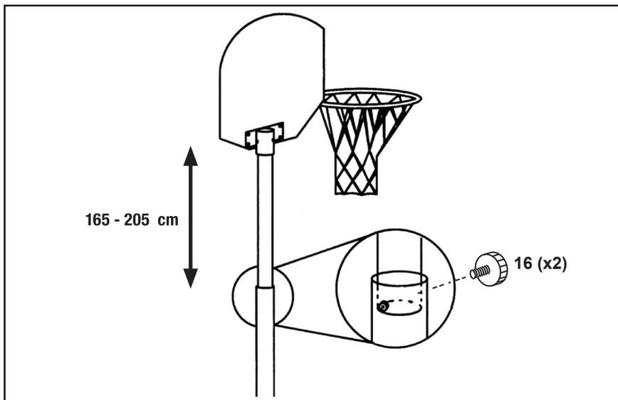
Desserrez les boulons du bouton (16) pour régler la hauteur. Serrez pour rester en place
