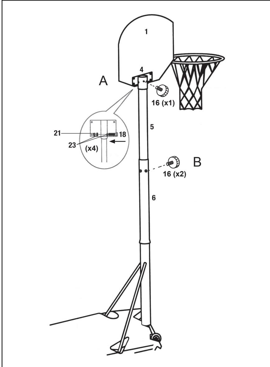
A. Placez la plaque de raccordement (4) sur le dessus du tube (5) et fixez-la en place avec un boulon à bouton (16) vissé dans le trou fileté à l'arrière du tube 5.
