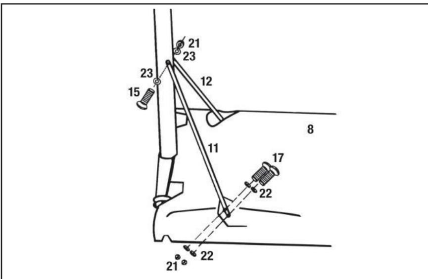
Fixez la base (8) au tube (7) en utilisant entretoise diagonale gauche et droite (11,12) avec boulons, rondelles et écrous comme illustré. *Remarque: deux rondelles sont utilisées sur chaque boulon, une de chaque côté de la pièce.*
