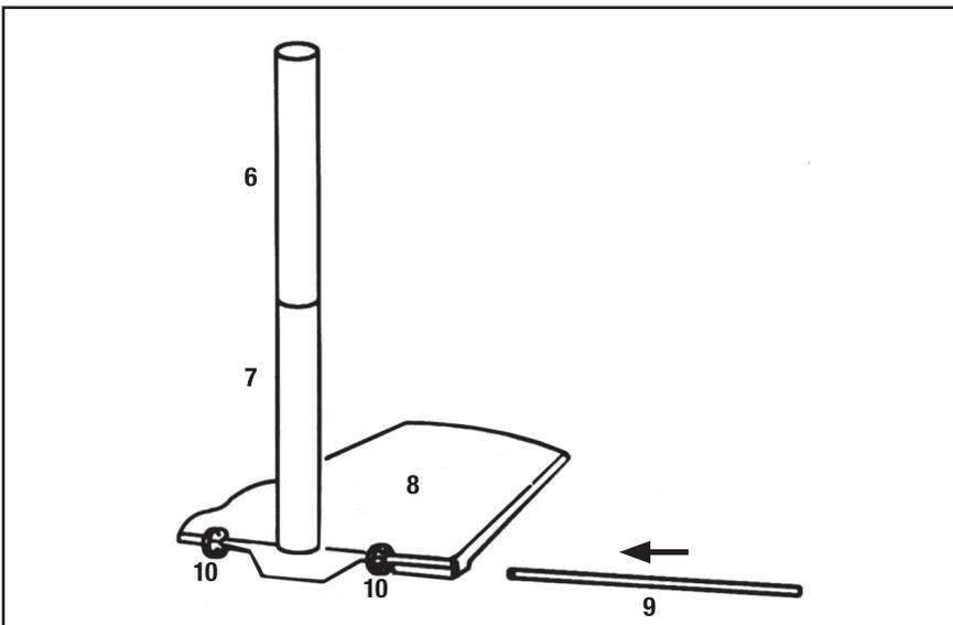
▲ Placer le tube (7) sur la base (8) comme illustré, et insérer l'axe (9) à travers la base, puis la roue (10), et revenir à travers la base, puis à travers le trou dans le tube (7). Continuez à travers la base du côté opposé, retournez dans la base, à travers l'autre Roue (10), et revenez dans la base. Appuyez sur l'extrémité de l'axe pour sécuriser à la base.
