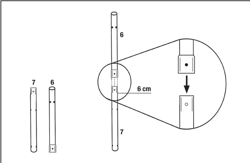
Fixez le tube (6) et le tube (7) ensemble en utilisant le bouton de verrouillage dans le trou. Assurez-vous d'avoir une connexion ferme.
