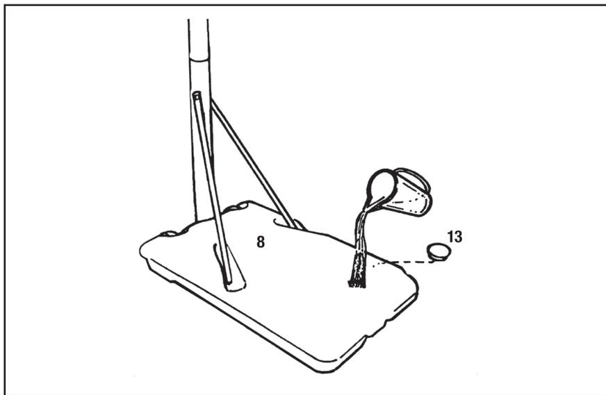
Retirez le bouchon de remplissage de la base (13) et remplissez la base d'eau. Replacer le capuchon
