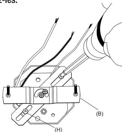
**4** À l'aide des serre-fils (J) fournis, connectez le fil blanc du luminaire au fil d'alimentation neutre (blanc). Connectez le fil noir du luminaire au fil d'alimentation chaud (noir). Connectez le fil de terre ou d'alimentation nu à la vis de terre de la barre transversale.
