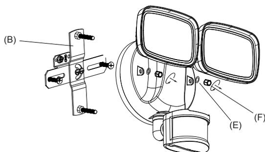
**3** Tirez les fils d'alimentation à travers le centre de la plaque ronde (G). Positionnez la plaque ronde (G) et la barre transversale (B) contre la J-Box et alignez les trous. Placez les vis J-Box (H) dans chaque trou et serrez-les.
