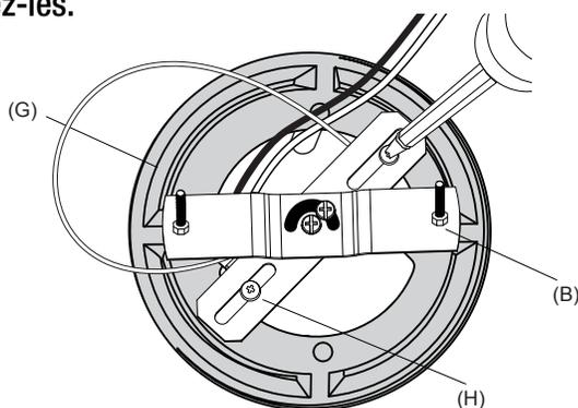
**4** À l'aide des serre-fils (J) fournis, connectez le fil blanc du luminaire au fil d'alimentation neutre (blanc). Connectez le fil noir du luminaire au fil d'alimentation chaud (noir). Connectez le fil de terre ou d'alimentation nu à la vis de terre de la barre transversale.
