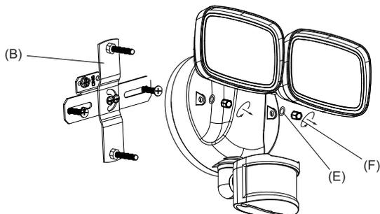
**3** Tirez les fils d'alimentation sur le côté et positionnez la barre transversale (B) contre le J-Box et alignez les trous. Placez les vis J-Box (H) dans chaque trou et serrez-les.
