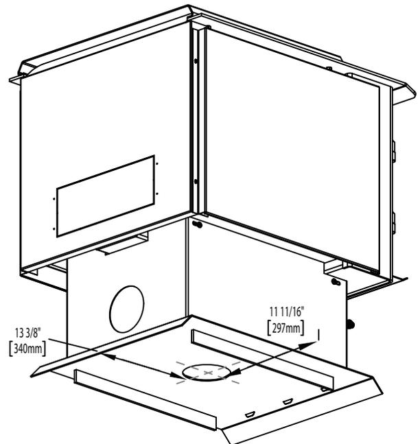
Le raccordement de la prise d'air sur l'extérieur peut se faire par l'arrière ou par la base du piédestal avec une prise d'air extérieur de 4" (102mm) de diamètre disponible chez votre détaillant autorisé.
