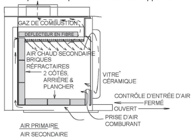
La chambre de combustion est revêtue de briques réfractaires à haute température sur deux côtés, l'arrière et le plancher. Le plafond est revêtu de déflecteurs en fibre afin de maintenir une température élevée dans la chambre de combustion. Ainsi, les gaz qui se mélangent à l'air préchauffé dans le tuyau d'air secondaire s'allument et brûlent facilement. Les côtés et l'arrière de l'appareil sont munis d'une deuxième paroi de façon à diriger la chaleur vers le haut et vers l'avant dans la pièce.
