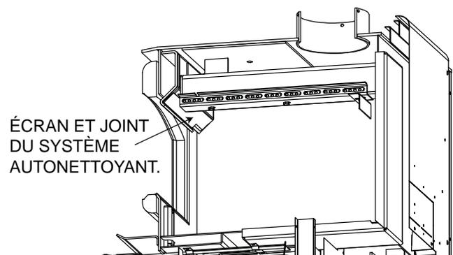
**REMARQUE:** Ne faites pas fonctionner l'appareil si l'écran du collecteur, l'écran et le joint du système autonettoyant ou le déflecteur en fibre sont détériorés ou manquants.
