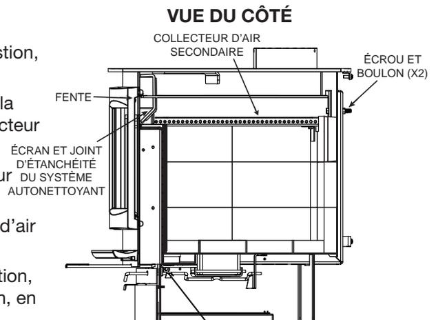
**REMARQUE:** PUSSEZ LE DÉFLECTEUR ENTIÈREMENT VERS L'ARRIÈRE DE LA CHAMBRE DE COMBUSTION, LAISSANT UN ESPACE MINIMAL DE 1 PO (25,4 MM) À L'AVANT. CECI PERMETTRA AUX FUMÉES DE BIEN ÊTRE ÉVACUÉES DE LA CHAMBRE DE COMBUSTION.
