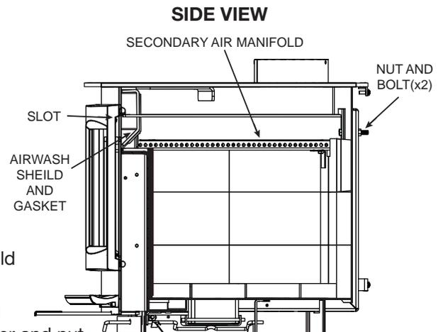
**NOTE:** PUSH THE BAFFLE ALL THE WAY TO THE REAR OF THE FIREBOX, LEAVING A MINIMUM OF 1" (25mm) GAP ALONG THE FRONT. THIS WILL ALLOW FLUE GASES TO PROPERLY ESCAPE THE FIREBOX.
