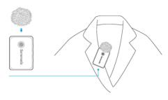
发射器支持裸机运动防风。在户外录音或有风的环境下,若想要更清晰的录音效果,可将防风毛套安装至发射器内置麦克风上。
