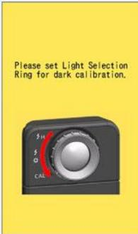
L'anello di selezione della luce ② è impostato su range H ⚡H (☉) o su range L ⚡ (☉) e non è stato possibile effettuare la calibratura scura.
