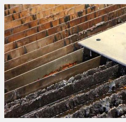
En plus de protéger les tables et les buses, les solutions de protection thermique à base de céramique peuvent également être appliquées aux surfaces environnantes pour éviter que les projections et les scories n'adhèrent à l'équipement exposé.
