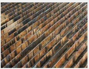
Une réduction des temps d'arrêt est synonyme d'augmentation de la productivité annuelle. De plus, le fait d'utiliser un protecteur thermique à base de céramique élimine les risques pour la santé et la sécurité associés aux procédés de nettoyage actuels comme le meulage et le gougeage. Les lattes protégées, et donc exemptes de scories, permettent à l'air de circuler pour une meilleure ventilation. La qualité de coupe s'en voit également améliorée puisque la surface de la table demeure plane.
