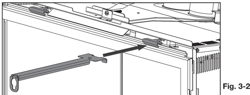
3. Inversez ces étapes pour réinstaller la barrière de protection et la porte. Assurez-vous que la barrière de protection est correctement installée.
