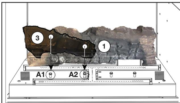
2. Placez les deux trous de la bûche #3 sur A1 et A2. Ne couvrez pas les orifices du brûleur.
