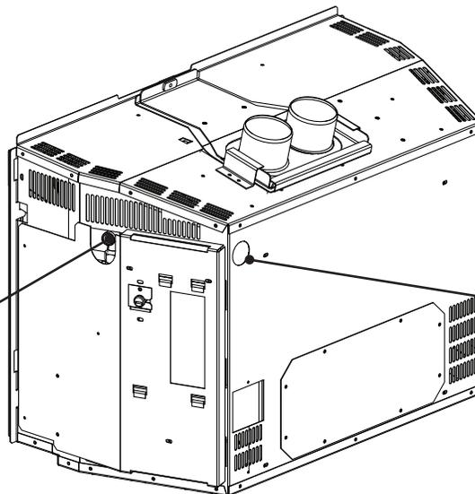
Knockout de gaz alternatif pour l'installation de gaz arrière.
