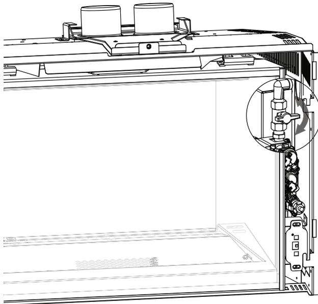
La soupape de fermeture est dans la position OFF lorsque la poignée est horizontale (voir l'illustration).
