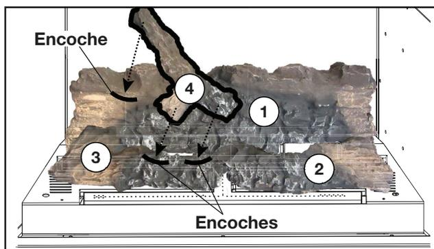
4. Placez la bûche #4 sur l'encoche gauche de la bûche #1 et les deux encoches de la bûche #3.
