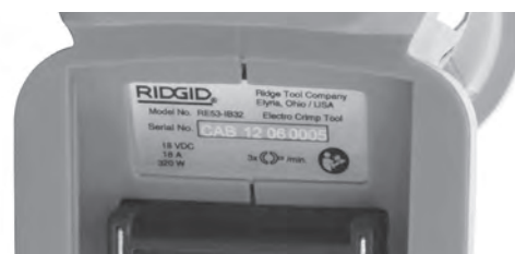
Рис. 4 – Серийный номер инструмента - первые 4 цифры (обведенные кружком) обозначают год и месяц изготовления. (12 = год, 06 = месяц).
