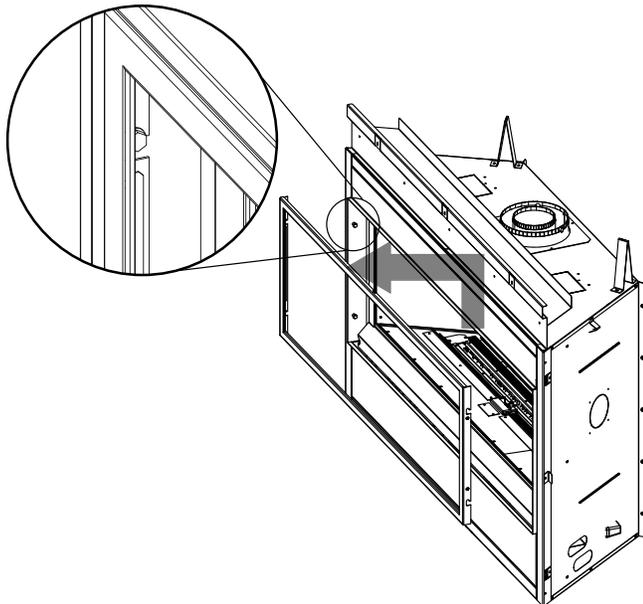
Avant d'enlever la porte vitrée, l'écran de protection doit être enlever. Soulevez l'écran de protection hors des 4 goupilles et enlever de l'appareil.
