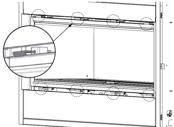
Laissez une main sur la porte vitrée pendant l'enlèvement de la porte. La porte vitrée est maintenur en place par quatre (CBLX42), six (CBLX46), ou huit pour (CBLX56) loquets. Tirez les poignées des loquets vers l'avant, puis retirez les loquets du cadre de porte afin de libérer de la porte. Pivotez ensuite le haut de la porte vers l'avant jusqu'à ce que vous puissiez saisir les côtés. Soulevez la porte hors du dispositif de retenu inférieur.
