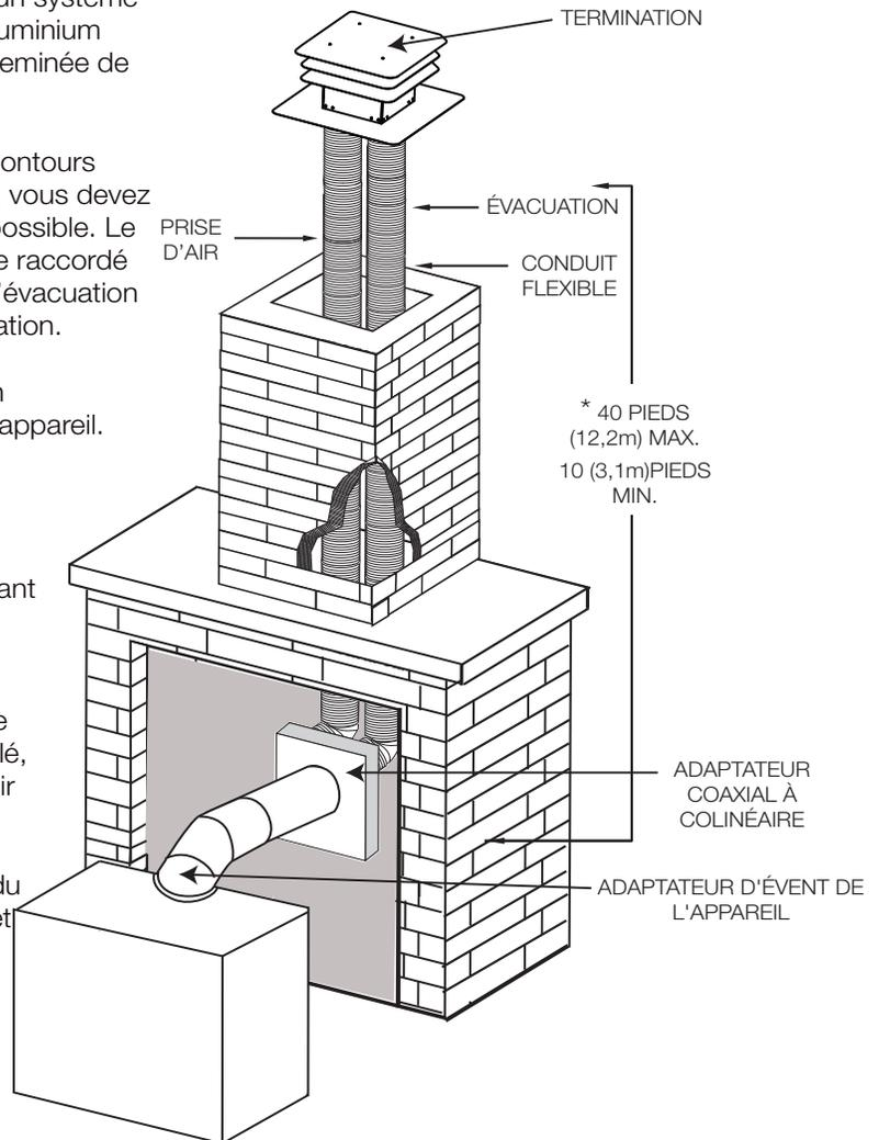
\* Mesurée à partir de la buse de l'appareil jusqu'au collet de la terminaison.
