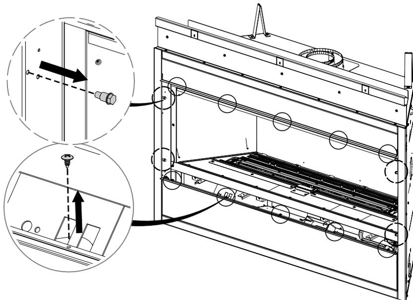
2. Installez la garniture supérieure de 1" (25 mm) et la garniture inférieure de 1 1/2" (38 mm) avec les brides tournées vers l'extérieur. Notez l'orientation de la garniture. Ajustez les garnitures à la profondeur souhaitée.
