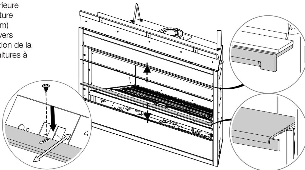
3. Installez les garnitures gauche (L) et droite (R) avec les brides tournées vers l'extérieur. Ajustez les garnitures à la profondeur souhaitée et serrez les vis et les boulons à épaulement.
