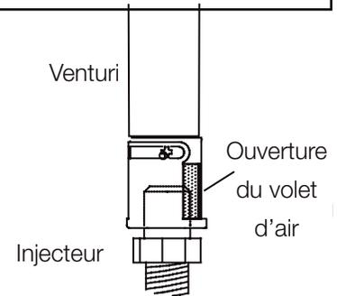
**Le réglage du volet d'air doit être exécuté par un technicien ou installateur qualifié!**
