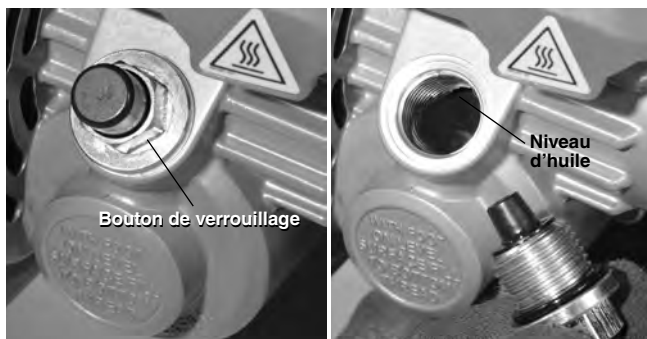
Figure 19 – Lubrification de la boîte d'engrenages
