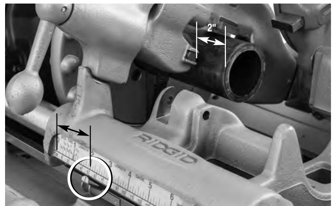
Figura 20 B – Puntero del calibrador de longitud en la longitud deseada
