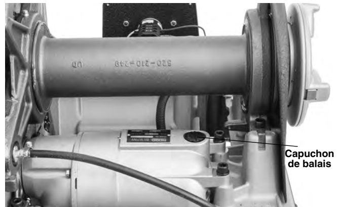
Figure 34 – Retrait du capot et remplacement des balais
