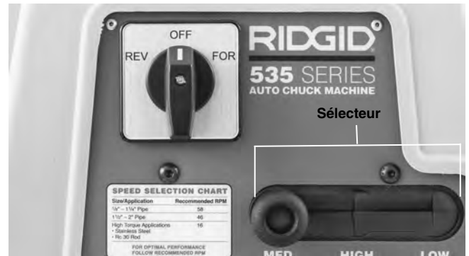
Figure 18 – Sélecteur de vitesses de la 535
