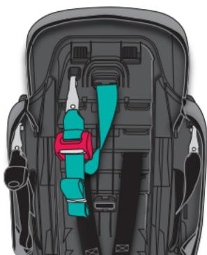
1. **Détacher le crochet d'ancrage et les connecteurs d'ancrage inférieur du dos du dispositif de retenue pour enfant.**
