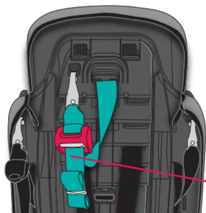
1. Détacher le crochet d'ancrage du dos du dispositif de retenue pour enfant.
