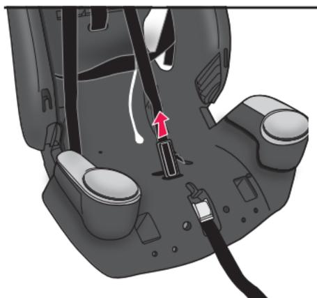
Tirer complètement l'ancrage au travers du siège et veiller à ce qu'il soit à plat.
