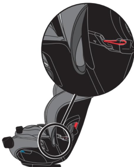
7. Desconecte los conectores autoadherentes en la parte inferior del cojín del respaldo y levante el cojín del asiento.
