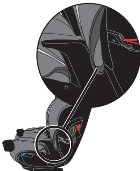
5. Vuelva a colocar el cojín de la cabecera. Pase la correa de sujeción a través de la ranura en la parte posterior del cojín del respaldo.
