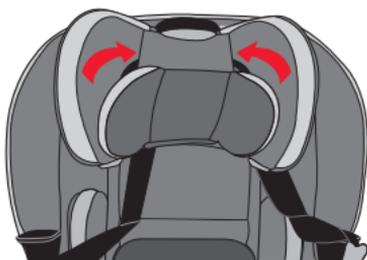
Inserte las lengüetas del cojín para la cabeza en las ranuras de la cabecera y fije los sujetadores autoadherentes en la parte posterior de la cabecera.
