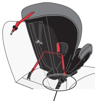
Apriete la correa al mover el asa hacia adelante y hacia atrás en el conector del anclaje inferior como se muestra hasta que el asiento esté apretado.
