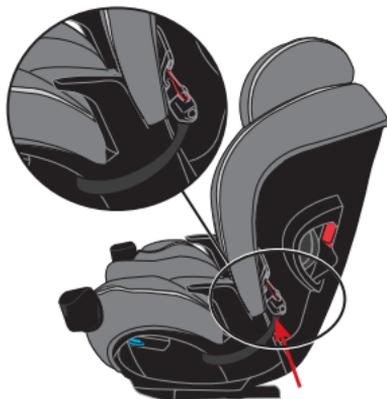
Almacenamiento del **anclaje inferior (SAU)** orientado hacia adelante
