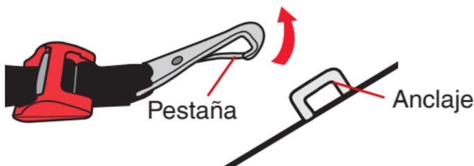
3. Cuando la correa de sujeción no está en uso, usted **DEBE** fijar el gancho a la parte posterior del sistema de sujeción infantil. **Una correa de sujeción y un gancho sueltos podrían lesionar a su niño.**
