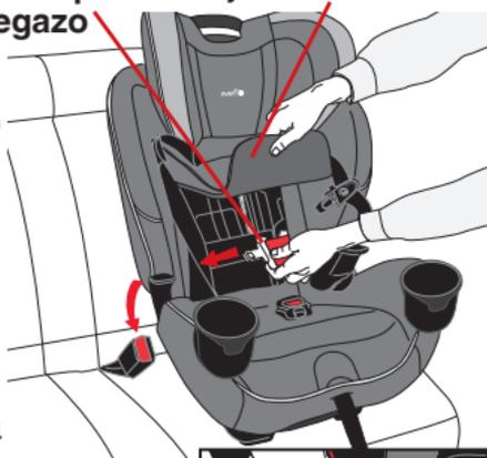
**IMPORTANTE:** Asegúrese de que el cinturón para regazo quede plano sin torcerse. **NO** utilice la guía del cinturón sólo con la instalación del cinturón de regazo.
