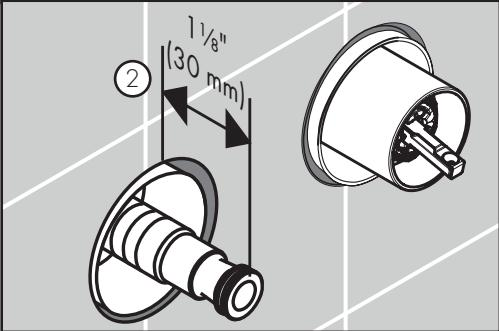
Installez la raccord fileté dans la pièce intérieure à l'aide d'une clé Allen de 12 mm.
