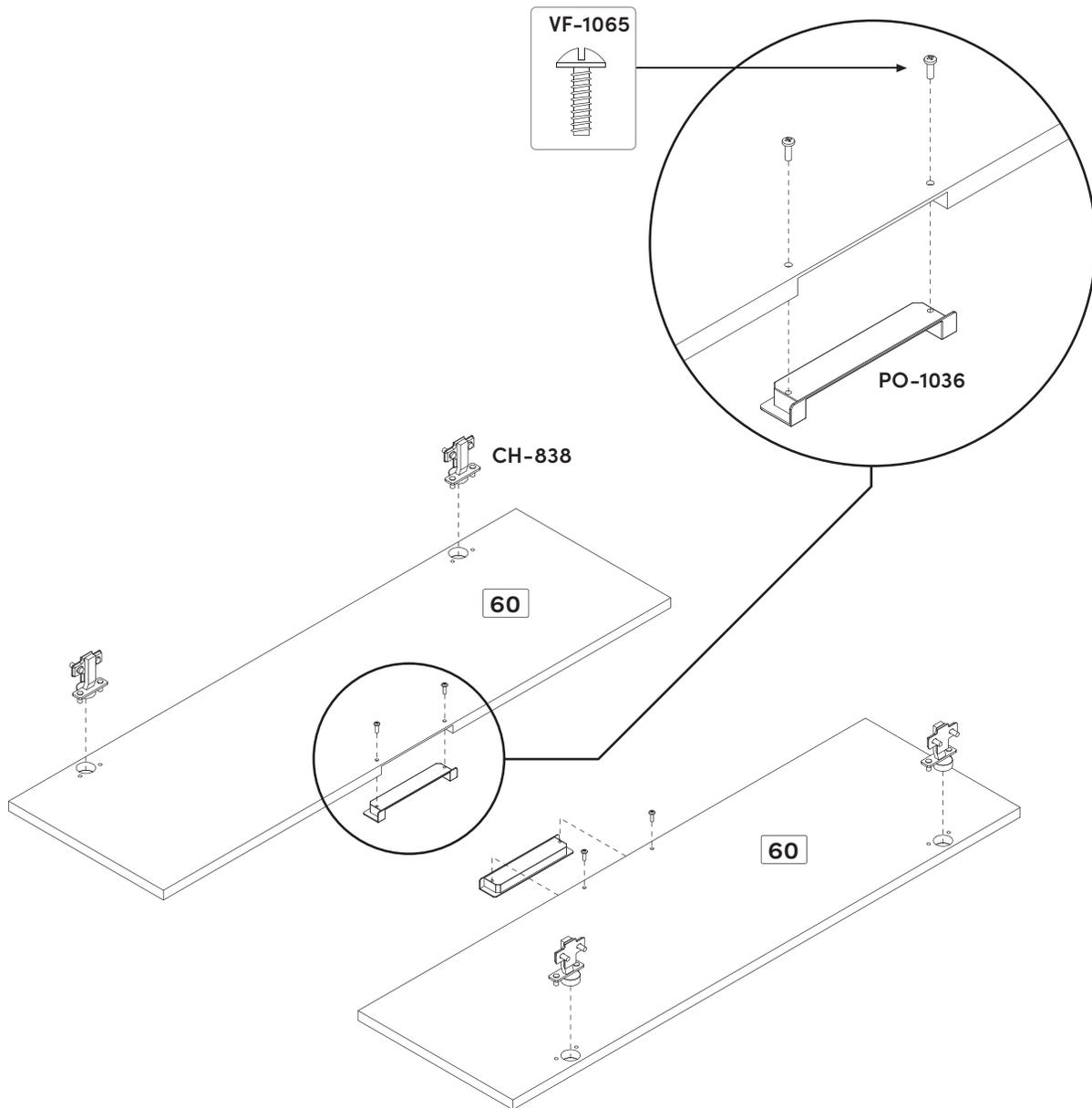
**9 Hardware installation & assembly** • Installation des quincailleries et assemblage • *Instalación de las quincallas y ensamblaje*
