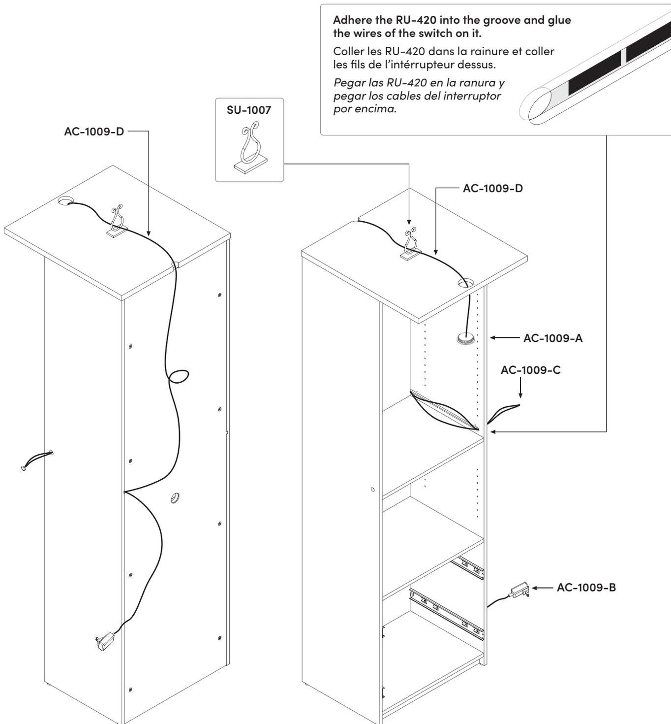
**5 Hardware installation & assembly** • Installation des quincailleries et assemblage • *Instalación de las quincallas y ensamblaje*
