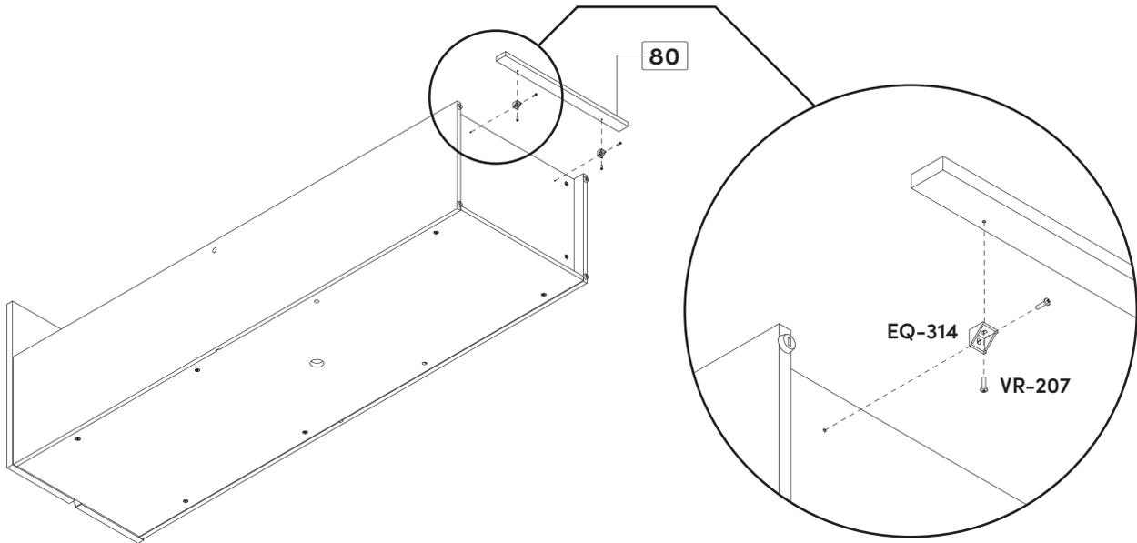
**4 Hardware installation & assembly** • Installation des quincailleries et assemblage • *Instalación de las quincaillas y ensamblaje*
