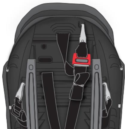
**1. Desconecte el gancho de la correa de sujeción de la parte trasera del sistema de sujeción infantil.**
