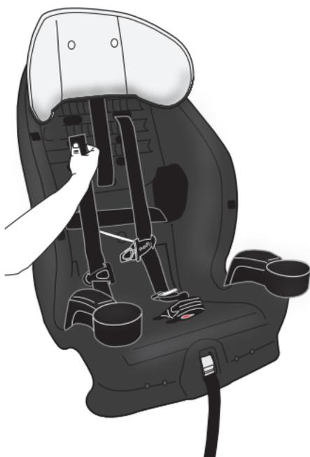
4. Pase las correas del arnés a través de las ranuras de ajuste, luego acople a la placa de unión.
