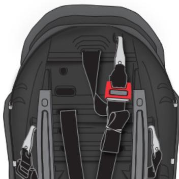
**1. Desconecte el gancho de la correa de sujeción y los conectores de anclaje inferior de la parte trasera del sistema de sujeción infantil.**
