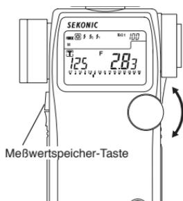
3. Zum Löschen eines ermittelten Wertes drücken Sie die M.CLEAR-Taste (23) oder wählen Sie mit dem Einstellrad bei gedrückter MODE-Taste eine andere Funktion.
