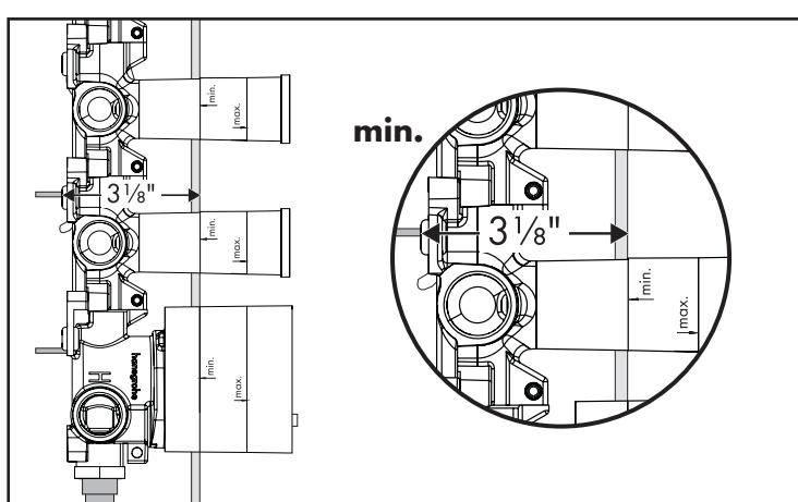
**Installez le robinet de façon à ce que la surface extérieure du mur fini se trouve entre les lignes « minimum » et « maximum ».**
