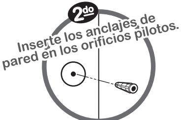
Inserte los anclajes de pared en los orificios pilotos.
