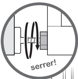
Utiliser les écrous de tension pour serrer les deux boulons de tension inférieurs.
