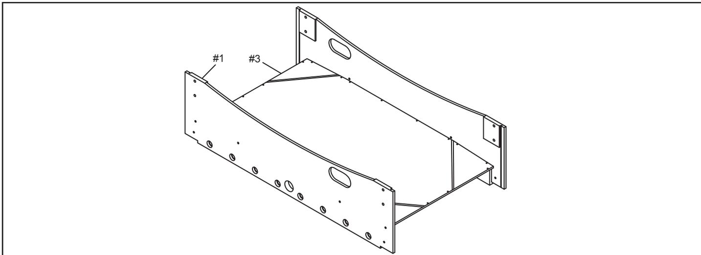
2. Installez un PANNEAU D'EXTRÉMITÉ (no 2) à chaque extrémité de la table à l'aide de boulons (no 10) et de rondelles (no 8).
