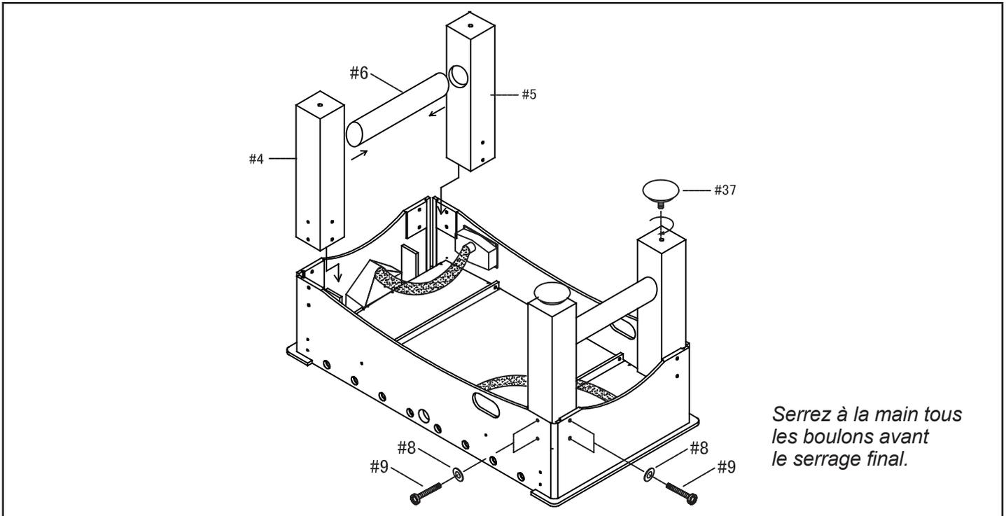
10. Commencez l'assemblage des TIGES DE JOUEURS en insérant partiellement la TIGE DE JOUEURS dans l'ouverture appropriée du PANNEAU LATÉRAL.
