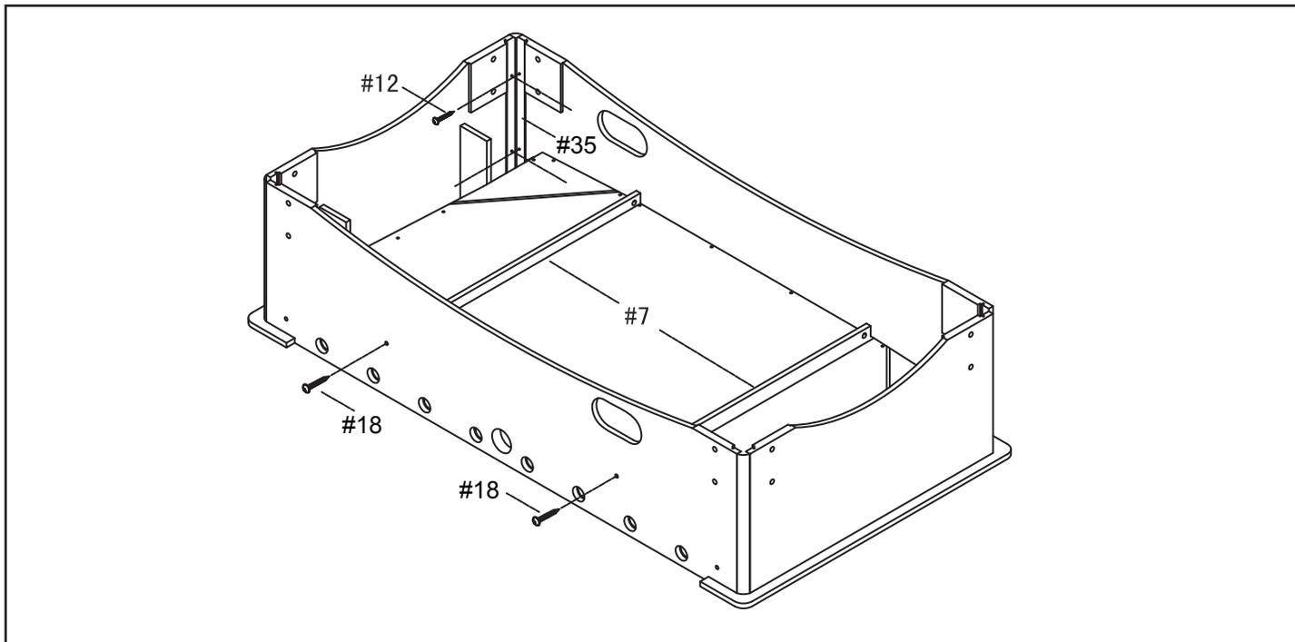
7. Installez la BOÎTE DE RÉCEPTION LATÉRALE (no 29) à chacun des PANNEAUX LATÉRAUX à l'aide de vis (no 12). Fixez la BOÎTE DE RÉCEPTION (no 30) à chacun des PANNEAUX D'EXTRÉMITÉ à l'aide de vis (no 12). Installez le RÉCUPÉRATEUR DE BALLES (no 28) sur la BOÎTE DE RÉCEPTION LATÉRALE et la BOÎTE DE RÉCEPTION, tel qu'illustré ci-dessous.
