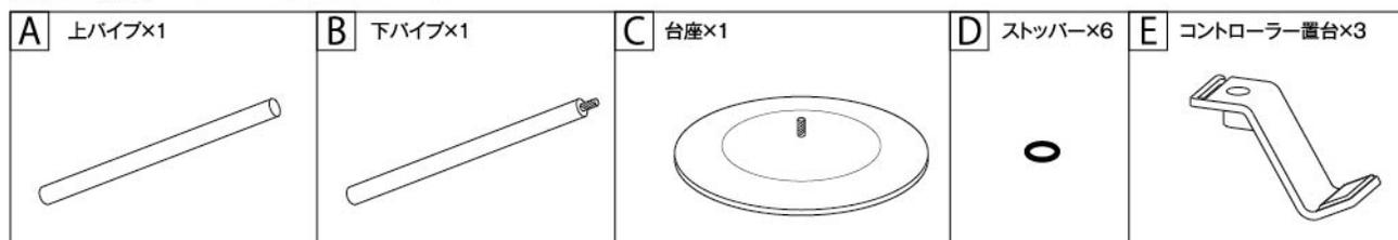
**1** 下図のように、台座と下パイプと上パイプをねじ込み、しっかりと固定します。
