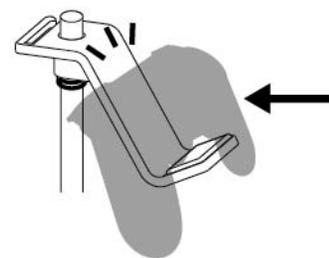
絶対にコントローラーを収納した状態で移動させたり置台を回転させないでください。
