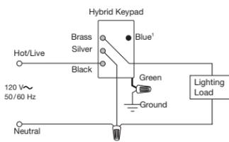
**Wiring Diagram 2a**
