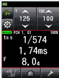
[ 闪光持续时间分析无线电触发模式闪光波形图界面 ]
