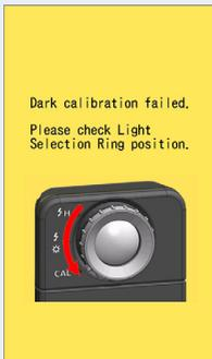
Se la calibratura del nero è stata effettuata ma non è stata completata normalmente. Impostare nuovamente l'anello di selezione della luce ② nella posizione di calibratura del nero **CAL** (🌑) ed eseguire la calibratura del nero ancora una volta.
