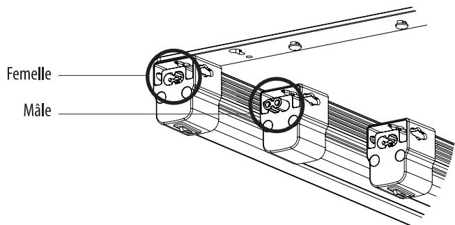
**4** Installez le cordon d'alimentation de 5 pi. Dans la prise du capuchon d'embout du premier projecteur. Utilisez des câbles connectables de 6 po pour connecter toutes les lampes de culture.
