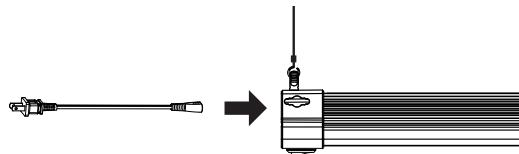
**7** Utiliser un collier de serrage pour attacher le cordon d'alimentation au câble d'accrochage.
