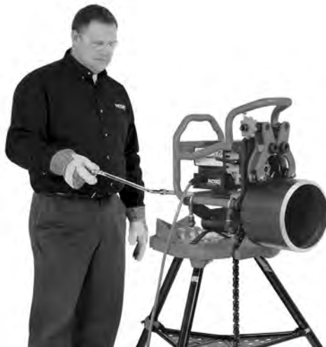
Abbildung 20C – Anfasen (fixiertes Anfasgerät/rotieren-des Rohr)
