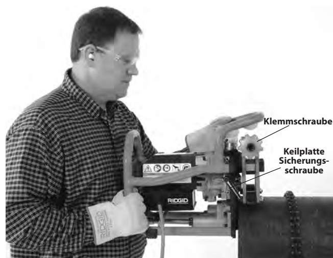
Abbildung 15A – Platzieren des Anfasgeräts am Rohr
