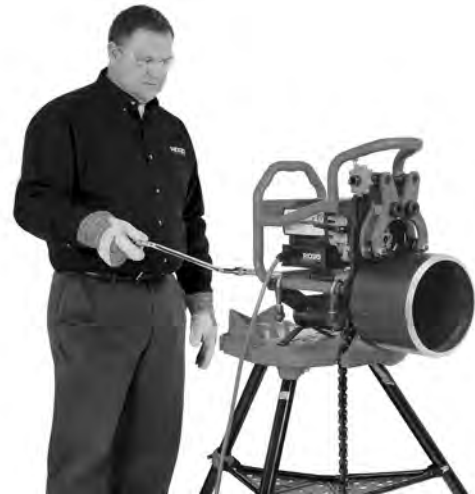
Figure 20C – Biseautage en cours (machine fixe/tuyau mobile)
