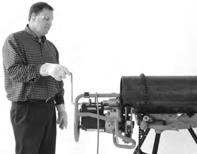
Abbildung 20B – Anfasen (fixiertes Werkstück/bewegtes Anfasgerät)
