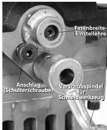
Abbildung 18 – Einstellung der Fasenbreite-Einstellehre
