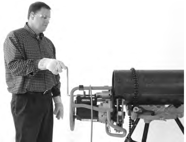
Figure 20B – Biseautage en cours (pièce fixe/machine mobile)
