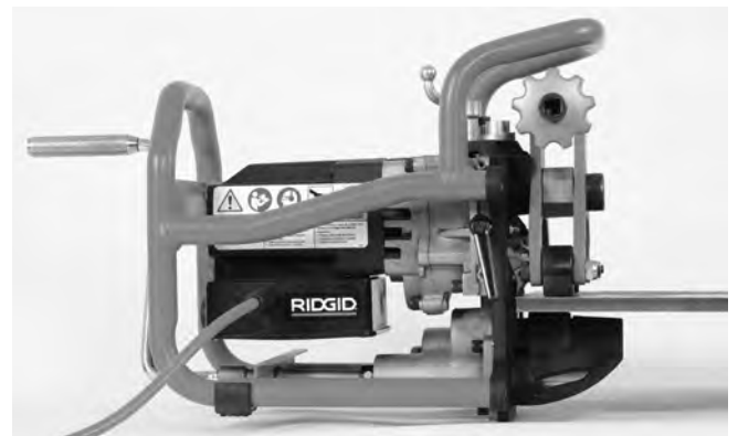
Figure 16B – Montage de la machine à biseauter sur tôle
