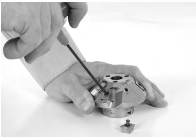
Figure 24 – Remplacement des couteaux
