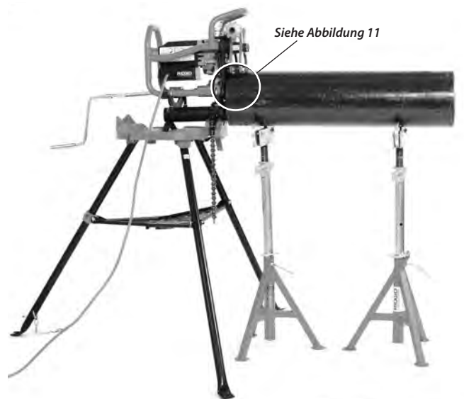
Abbildung 13 – Fixiertes Anfasgerät, langes Rohr, mehrere Rohrstände
