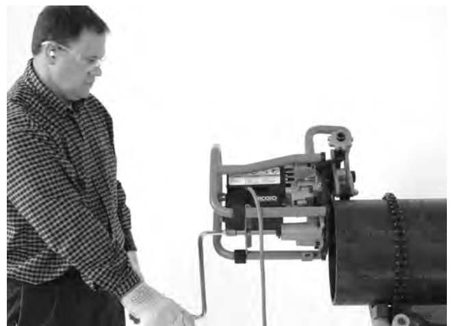
Abbildung 20A – Anfasen (fixiertes Werkstück/bewegtes Anfasgerät)
