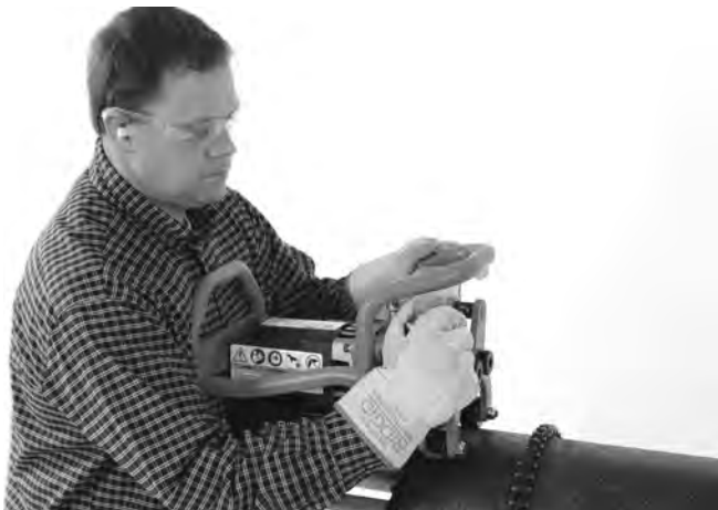
Figure 17A – Serrer la vis de blocage manuellement
