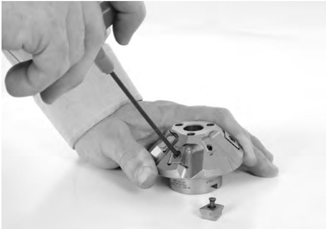
Abbildung 24 – Wechseln der Schneideinsätze
