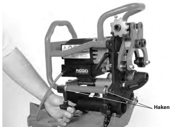
Abbildung 9 – Sichern des Anfasgerätes am Adapter
