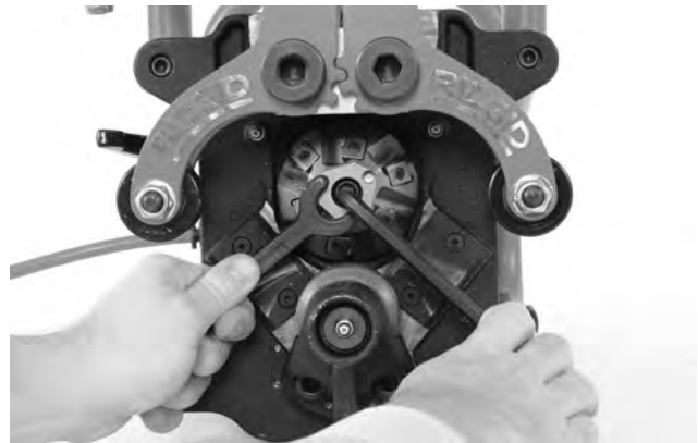
Abbildung 25A – Wechseln von Schneidköpfen
