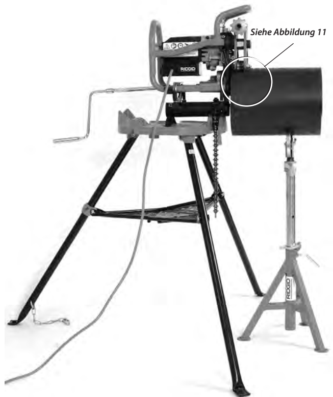
Abbildung 12 – Fixiertes Anfasgerät, kurzes Rohr, ein Rohrständer
