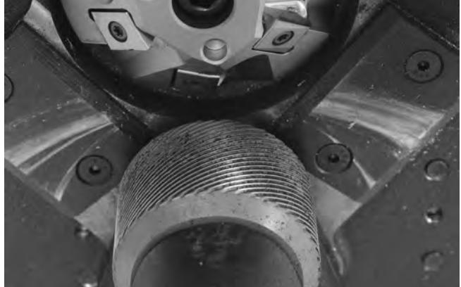
Figure 22 – Nettoyage du moletage du galet d'entraînement
