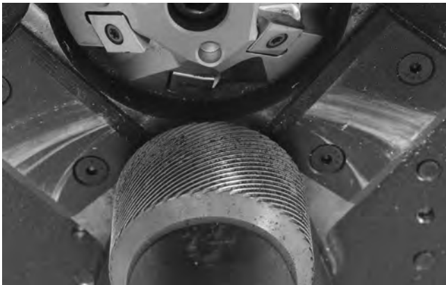
Abbildung 22 – Reinigen der Rändelung der Antriebsrolle
