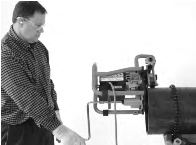
Figure 20A – Biseautage en cours (pièce fixe/machine mobile)
