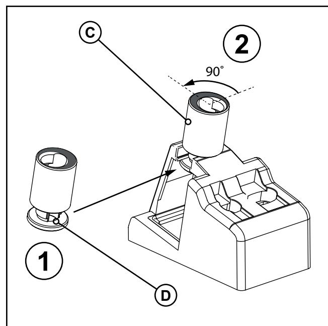
Le support est conçu pour tenir la mini-baguette avec une brosse (A) ou un insert (B) installé.
