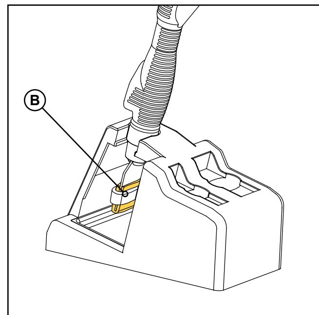
El soporte está diseñado para guardar la mini varilla con un cepillo (A) o un inserto (B) instalados.
