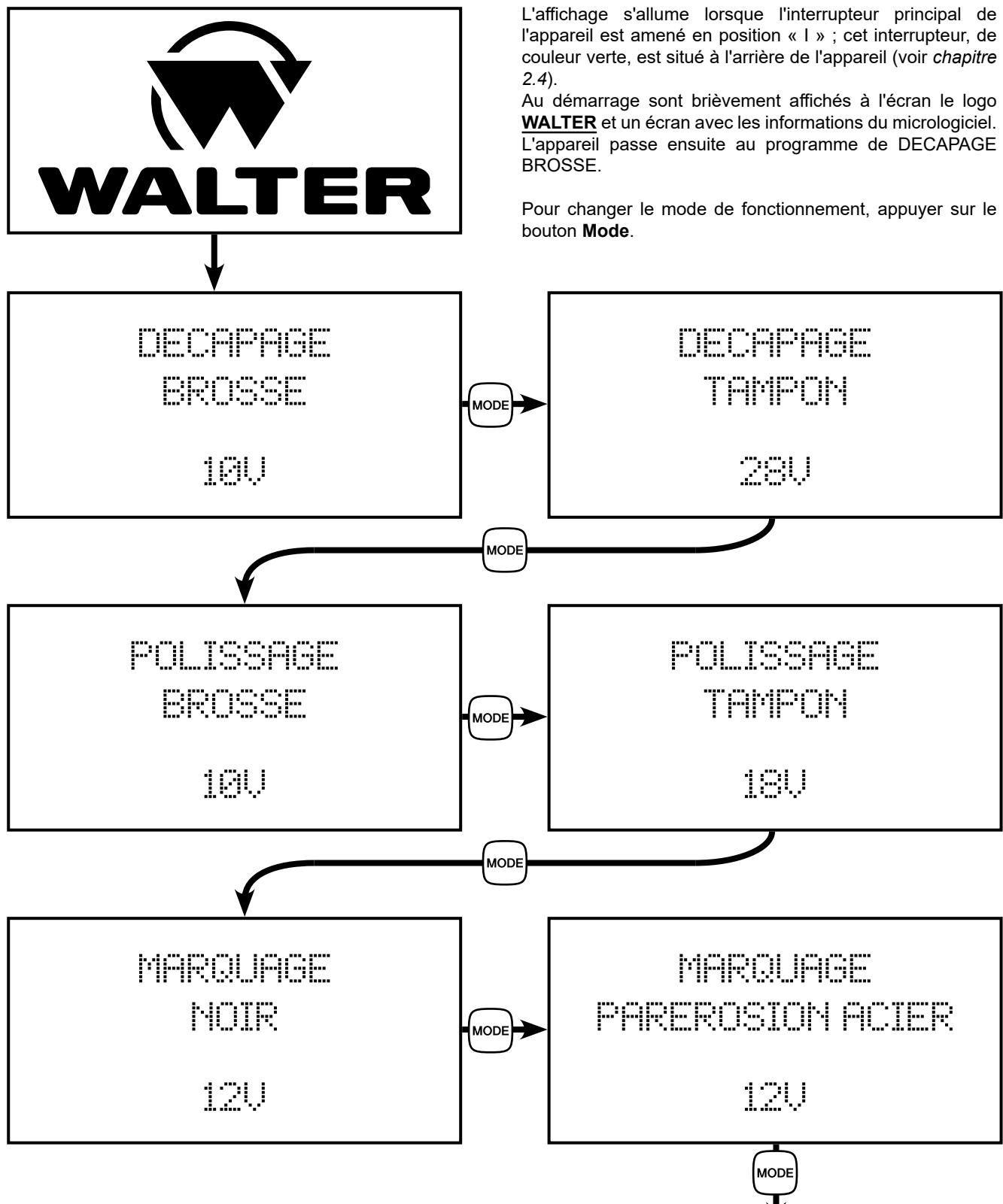
Quel que soit le programme sélectionné, les touches – et + peuvent être utilisées pour augmenter ou diminuer la tension de fonctionnement (par incrément de 1 volt). **Le niveau de tension par défaut dans les différents modes de fonctionnement est celui recommandé par le fabricant.**
