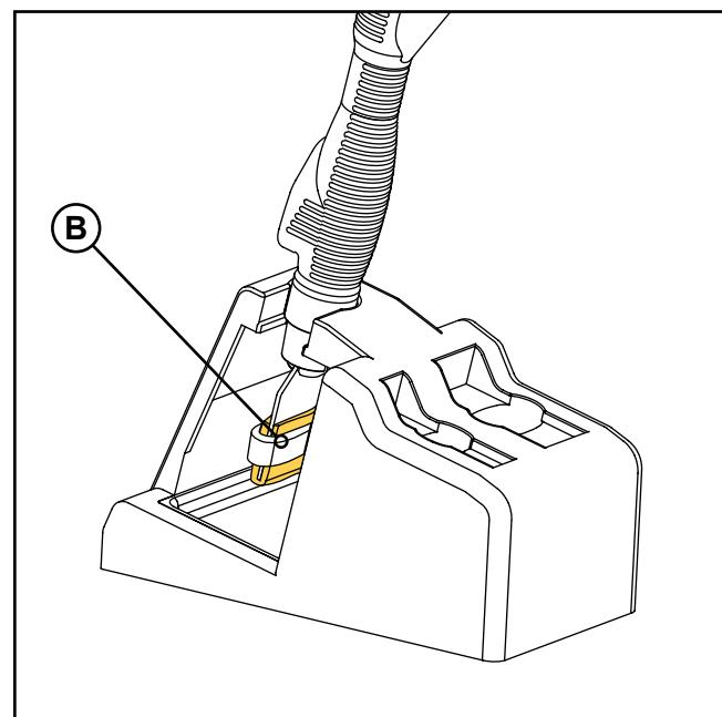
O suporte foi concebido para guardar a mini varinha com uma escova (A) ou um inserto (B) instalado.
