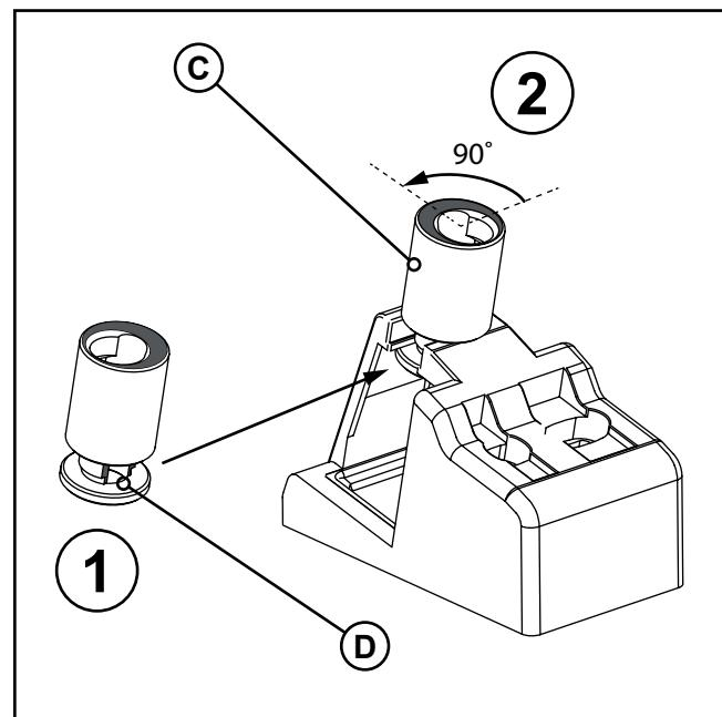
No final do processamento, guarde sempre a varinha e outros acessórios de forma adequada.
