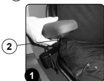
**NOTA:** Tomando como referencia el brazo derecho, si se gira la ruedecilla hacia afuera de la máquina, se aumenta la inclinación del brazo. Tomando como referencia el brazo izquierdo, si se gira la ruedecilla hacia el interior de la máquina, se aumenta la inclinación del brazo.
