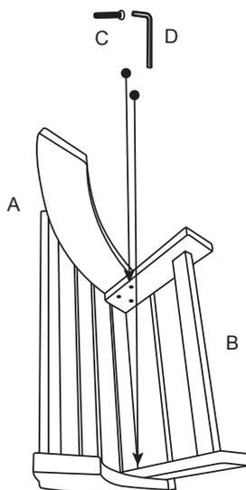
Utilisez 3 boulons (C) de chaque côté pour fixer la jambe (B) au panneau du repose-pieds (A) avec une clé Allen (D).
